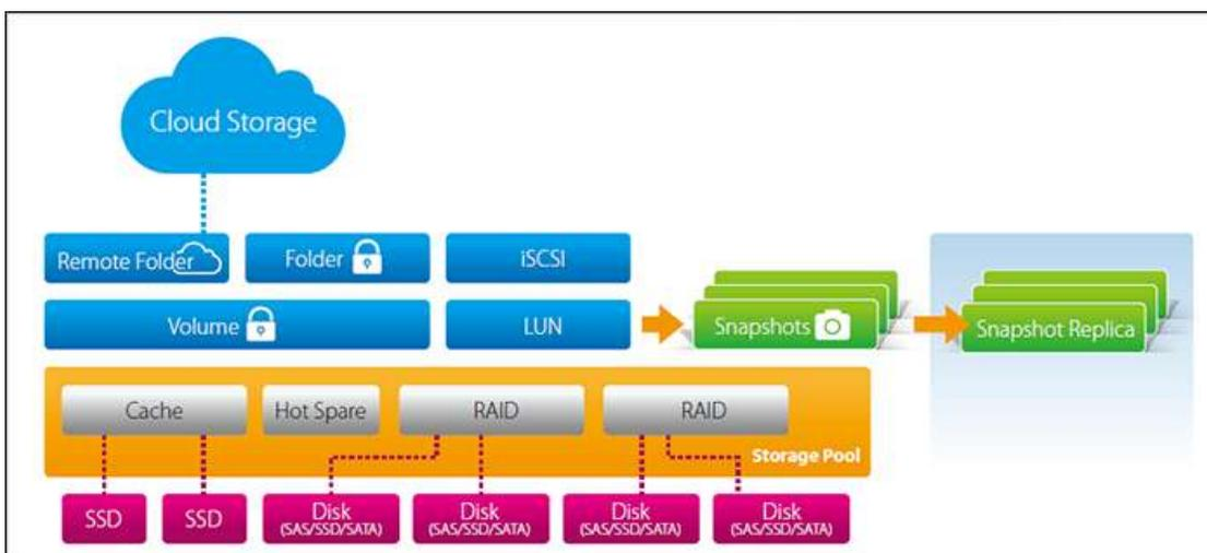
各層はストレージシステムの 1 つの側面をカバーするように設計されており、4 層全部が組み合わさり、ストレージシステムが総合的に保護されます。
