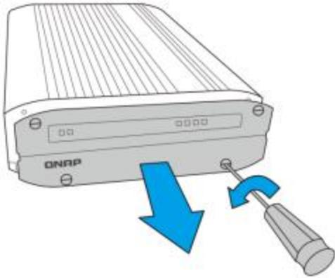
2. Entfernen Sie den Laufwerkseinsatz.
