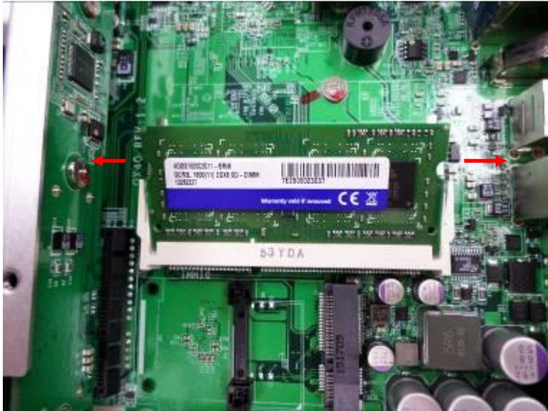
**Hinweis: Achten Sie immer darauf, dass ein Speichermodul im primären Steckplatz an der Oberseite installiert ist (mit „DIMM1“ gekennzeichnet). Andernfalls startet das System nicht.** Achten Sie bei der Installation von zwei Speichermodulen darauf, dass sie in beiden Speichersteckplätzen die gleiche Größe haben und idealerweise vom selben Typ/Modell sind.
