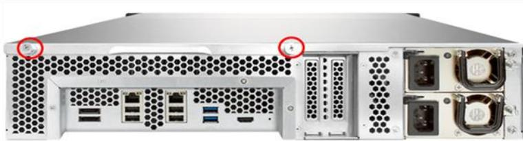
4. Ergreifen Sie die Vertiefung an der oberen Abdeckung. Nehmen Sie die obere Abdeckung mit beiden Händen ab.
