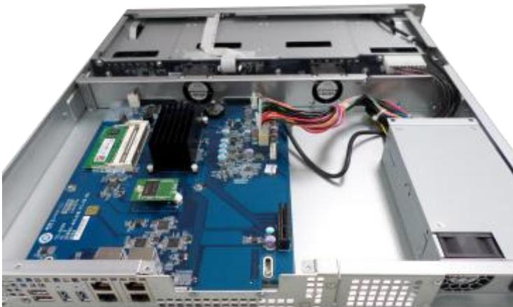
3. Schieben Sie das Speichermodul in einem 45-Grad-Winkel (circa) in den Steckplatz.
