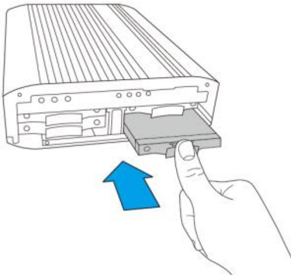
5. Wiederholen Sie zur Installation der restlichen Laufwerke die Schritte 2 bis 4. Bitte beachten Sie dabei die in Schritt 2 angezeigte Festplattenreihenfolge.
