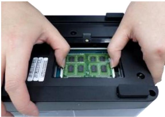
**Hinweis: Achten Sie immer darauf, dass ein Speichermodul im primären (roten) Steckplatz installiert ist. Andernfalls startet das System nicht.** Achten Sie bei der Installation von zwei Speichermodulen darauf, dass sie in beiden Speichersteckplätzen die gleiche Größe haben und idealerweise vom selben Typ/Modell sind.
