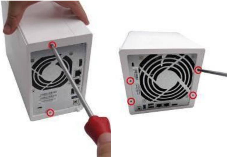
2. Entfernen Sie vorsichtig die Gehäuseabdeckung des NAS, indem Sie sie auseinanderschieben (prüfen Sie anhand der optischen Anzeigevorrichtungen auf der Unterseite des NAS, ob das NAS-Gehäuse verriegelt/entriegelt ist).
