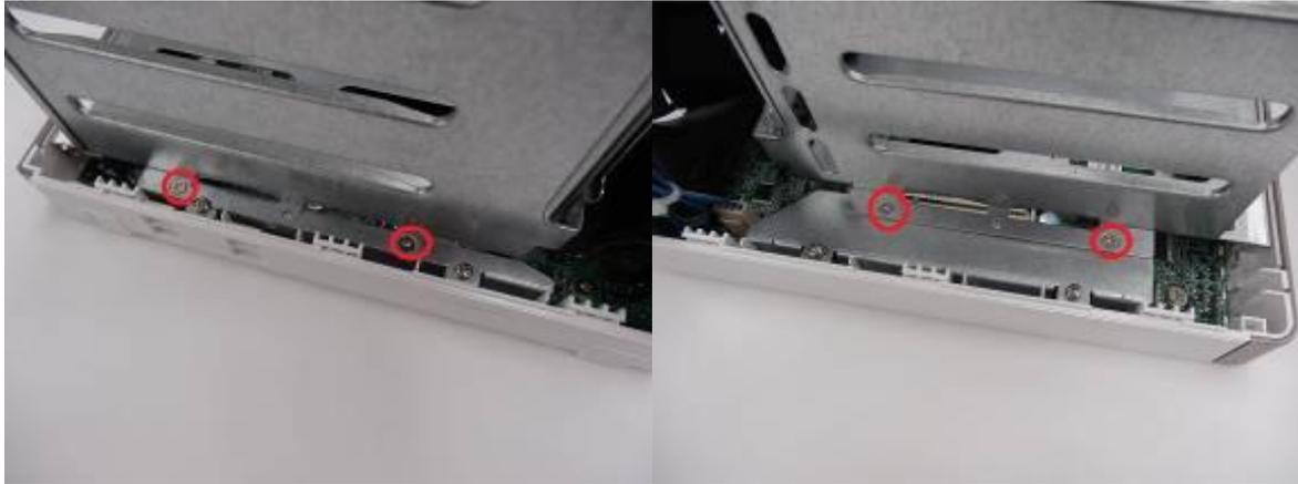
4. Bei einem NAS mit 4 Einschüben müssen Sie auch die zwei Schrauben oben am Festplattenkäfig entfernen.
