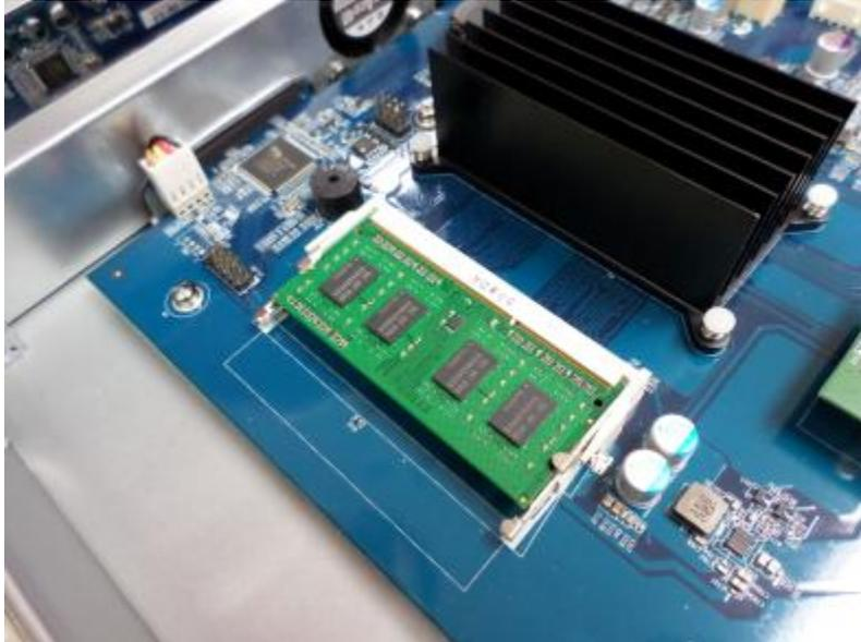
**Hinweis: Für die Modelle TS-x53U & TS-451U muss stets gewährleistet sein, dass ein Speichermodul im primären Steckplatz (in nachstehender Abbildung im roten Rechteck) installiert ist, denn sonst fährt sich das System nicht hoch.** Achten Sie bei der Installation von zwei Speichermodulen bitte darauf, dass sie in beiden Speichersteckplätzen die gleiche Größe haben und idealerweise vom selben RAM-Typ sind. Die unterstützte Speicherkombination beträgt maximal 8 GB.
