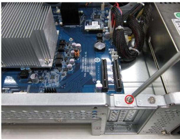
6. Ergreifen Sie den Rand der Netzwerkerweiterungskarte. Bringen Sie die Kerbe am goldenen Rand der Karte mit der Karte im PCIe-Steckplatz in Übereinstimmung. Schieben Sie die Netzwerkerweiterungskarte bis zum Anschlag in den PCIe ein.
