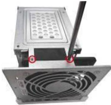
5. Entfernen Sie den Festplattenkäfig vorsichtig aus dem NAS, indem Sie ihn aus seinem Steckplatz herausheben.
