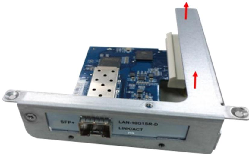
7. Entfernen Sie die Netzwerkerweiterungskarte/-halterung.
