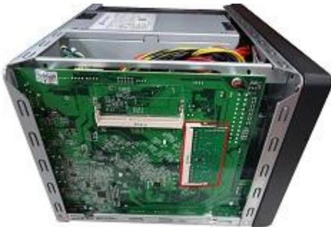
4. Greifen Sie das Speichermodul an der Kante. Richten Sie die Kerbe an der goldenen Kante des Moduls an der Kerbe im Speichersteckplatz aus. Schieben Sie das Speichermodul im 45-Grad-Winkel (etwa) in den Steckplatz.
