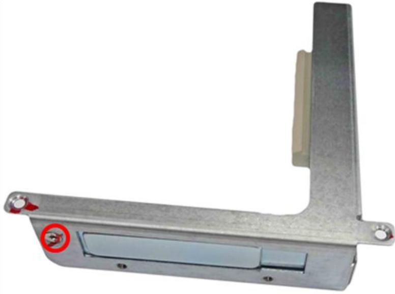
8. Stecken Sie die neue Netzwerkerweiterungskarte so weit wie möglich in das Riser-Kartenmodul. Ziehen Sie dann die Schraube fest.
