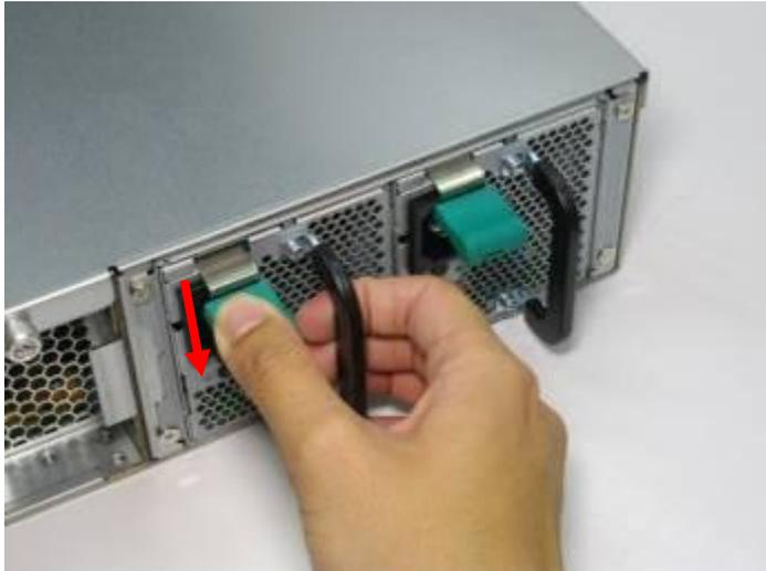
3. Ziehen Sie das defekte Stromversorgungsmodul heraus.
