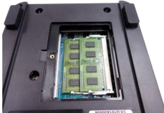
4. Schließen Sie die NAS-Abdeckung, ziehen Sie die Schraube fest. Schließen Sie Netzteil und Netzkabel wieder an das NAS an.
