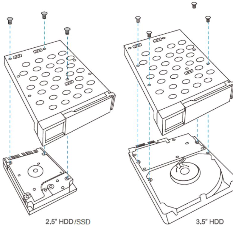
3. Stecken Sie die Festplatteneinsätze bis zum Anschlag in das NAS und drücken Sie den Riegel zurück, bis Sie ein Klickgeräusch hören.
