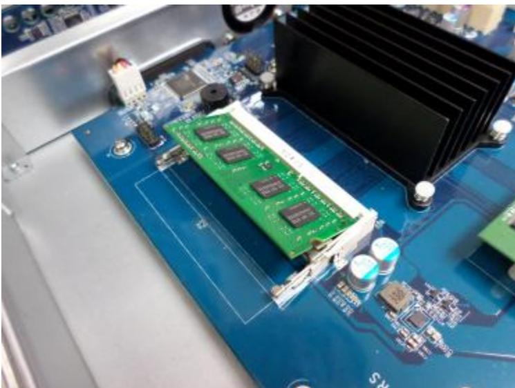
4. Drücken Sie das Speichermodul nach unten. Stellen Sie sicher, dass das Speichermodul richtig sitzt und die Clips angebracht sind.
