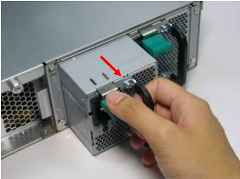
4. Schieben Sie das neue Stromversorgungsmodul in den NAS.
