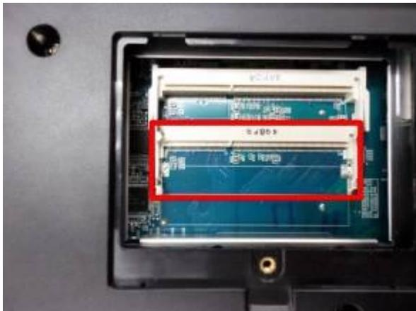
3. Schieben Sie das Speichermodul in einem 45-Grad-Winkel (etwa) in den Steckplatz, drücken Sie das Speichermodul nach unten, bis es einrastet. Vergewissern Sie sich, dass das Speichermodul sicher durch die Klemmen gehalten wird.
