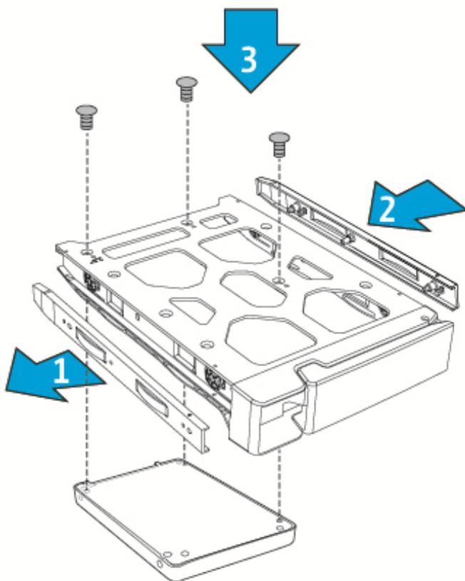
4. Stecken Sie den Festplatteneinsatz vollständig bis zum Boden in das Turbo NAS,
