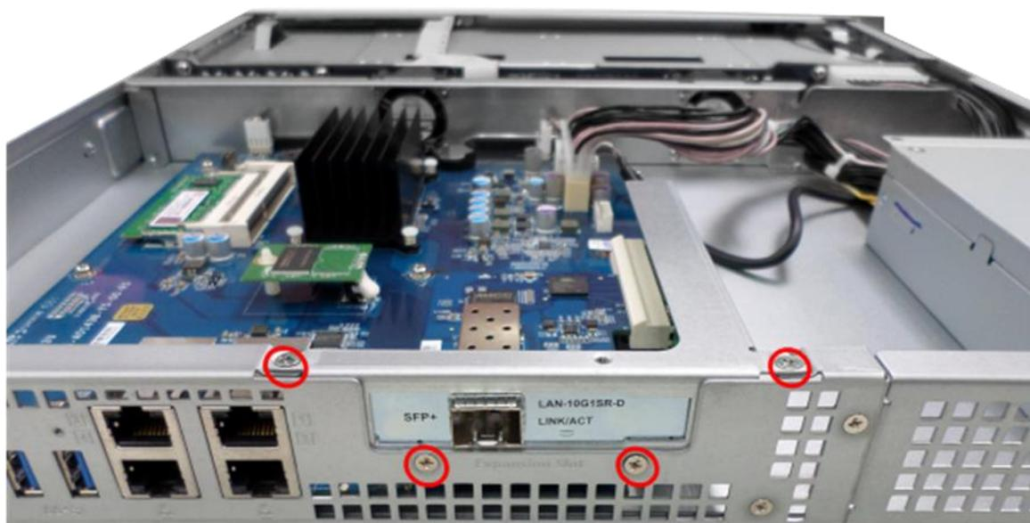
6. Greifen Sie die Metallkante des Riser-Kartenmoduls. Entfernen Sie das Modul vorsichtig.
