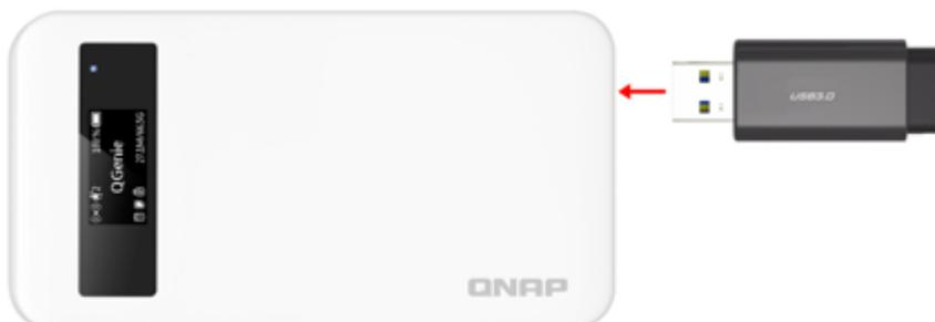
Se il dispositivo di archiviazione USB è inserito correttamente, la schermata OLED QGenie mostrerà l'icona USB nell'indicatore di archiviazione. Gli utenti possono accedere ai dati nel dispositivo di
