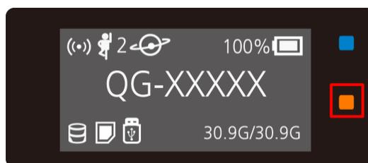
3. Quando la carica di QGenie sarà completa, l'indicatore di batteria OLED visualizzerà il 100%.
