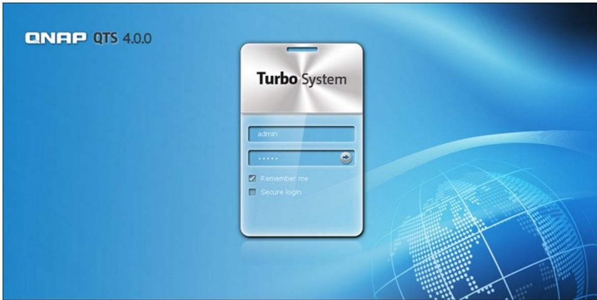
**注意：** 預設 NAS IP為 169.254.100.100:8080。如果已將 NAS設為使用 DHCP，您可以使用 QNAP Qfinder檢查 NAS的 IP位址。請確定 NAS和執行 QNAP Qfinder的電腦均連線至相同子網路。如果找不到 NAS，請將 NAS直接連線至電腦，然後再次執行 QNAP Qfinder。
