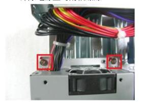
6. 剪斷斷橋束繩 (cable tie),將磁碟背板電源拔下
