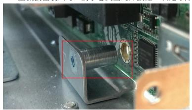
2. 請先將散熱風扇放入後,對準螺絲孔並鎖上
