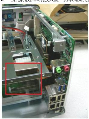
3. 將磁碟背板裝回至主機板上,並鎖回三處螺絲
