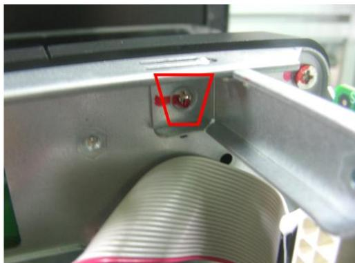
9. 需將三處螺絲卸除，即可將磁碟背板卸下
