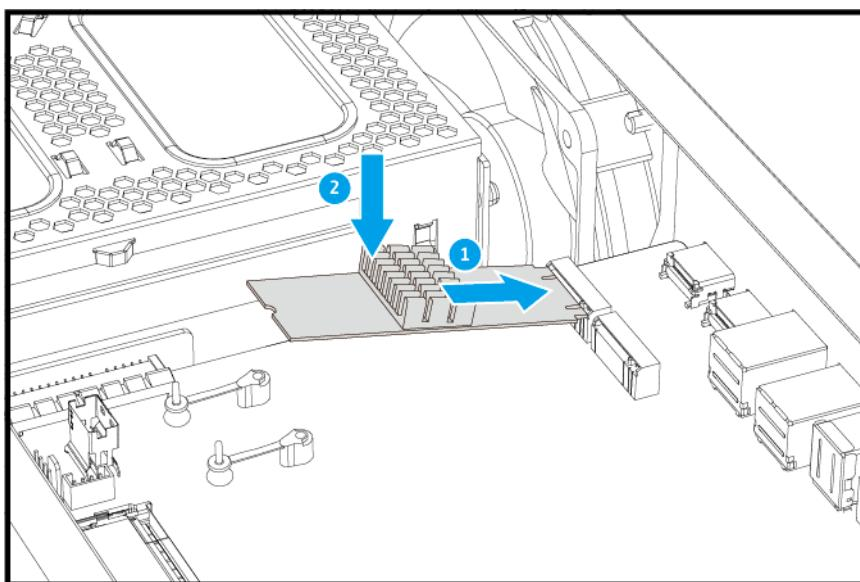
d. プッシュピンを挿入してドライブを固定します。
