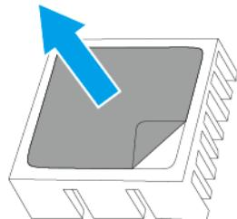
c. ヒートシンクをコントローラーに取り付けます。
