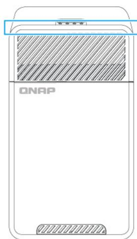
Ce voyant indique l'état du système et des informations connexes lorsque l'appareil est sous tension. Les informations suivantes sur les voyants ne s'appliquent que lorsque l'appareil est allumé et connecté à un réseau.
