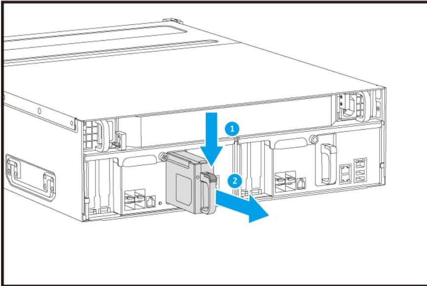
2. Setzen Sie die neue BBU in den Steckplatz ein, bis sie einrastet.
