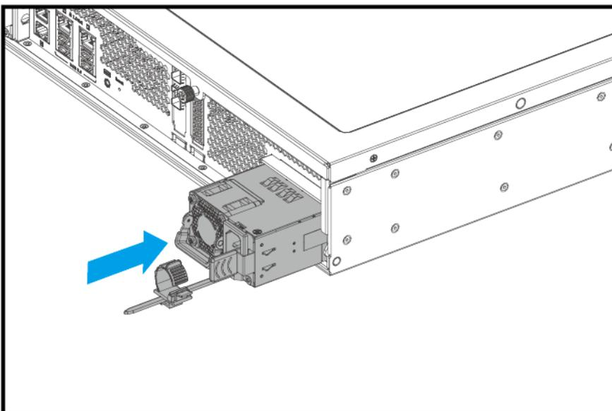
5. Collegare il cavo di alimentazione alla PSU e alla presa elettrica.
