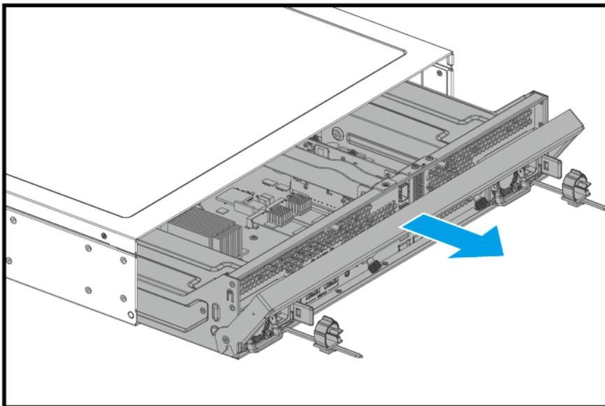
**5. Entfernen Sie die PCIe-Abdeckung.**
