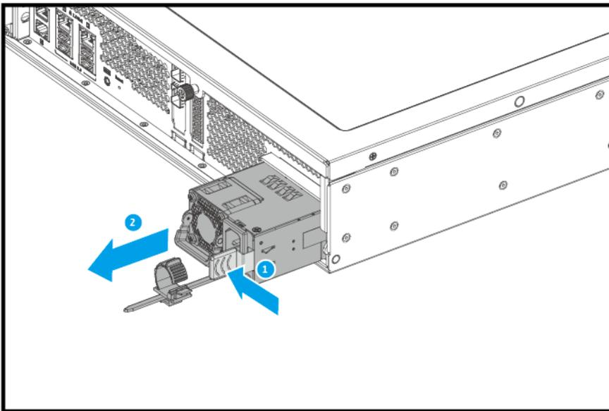
4. Setzen Sie die neue PSU ein.
