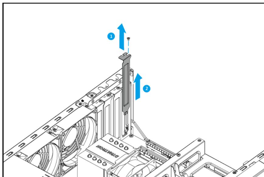
**6.** Volitelné: Připevněte držák s plnou výškou k rozšiřující kartě.
