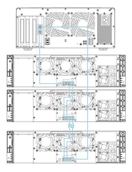
QNAP empfiehlt, immer eine Dual-Pfad Konfiguration zu verwenden, um Speicherstillstände aufgrund von Ausfall des Erweiterungsgeräts oder Kabeltrennung zu vermeiden. Die Einzel-Pfad Konfiguration sollte nur in einer Situation verwendet werden, in der es nicht möglich ist, die Dual-Pfad Konfiguration zu verwenden.
