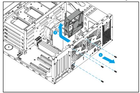
**b.** Trennen Sie das Lüfterkabel von der Systemplatine.
