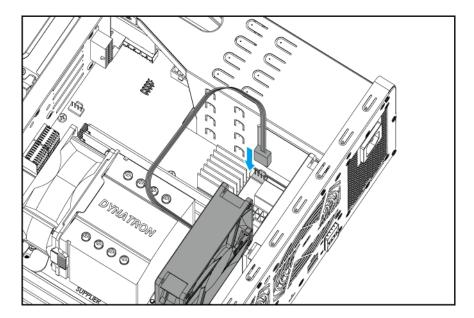
**c.** Bringen Sie die Schrauben an, mit denen das Lüftermodul am Gehäuse gesichert wird.
