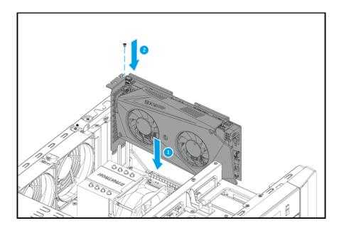
**d.** Optional: Bringen Sie den PCIe-Netzanschluss an der Erweiterungskarte an.
