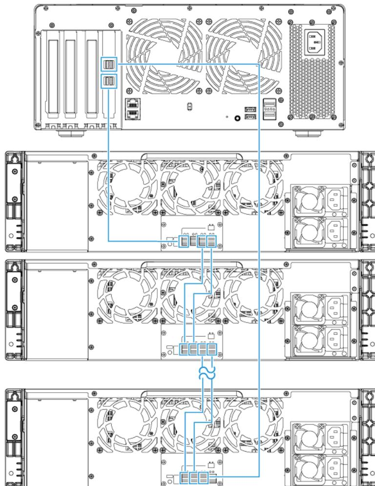
QNAP recommande de toujours utiliser la configuration double chemin, afin d'empêcher le temps d'arrêt du stockage en cas de panne de l'unité d'extension ou de déconnexion d'un câble. N'utilisez la configuration à chemin unique que dans une situation où vous ne pouvez pas utiliser la configuration double chemin.
