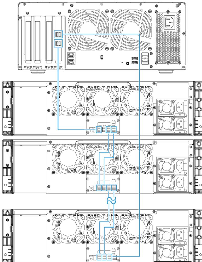
QNAP consiglia di usare sempre una configurazione a due percorsi per evitare l'inattività dell'archiviazione dovuta a malfunzionamenti dell'unità di espansione o lo scollegamento del cavo. La configurazione a singolo percorso deve essere usata solo in casi in cui non è possibile usare la configurazione a due percorsi.
