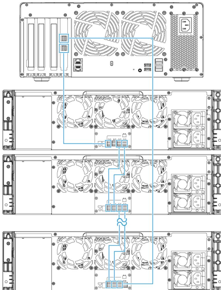
QNAP は、拡張ユニットの不具合やケーブルの切断によるストレージのダウンタイムを防ぐため
