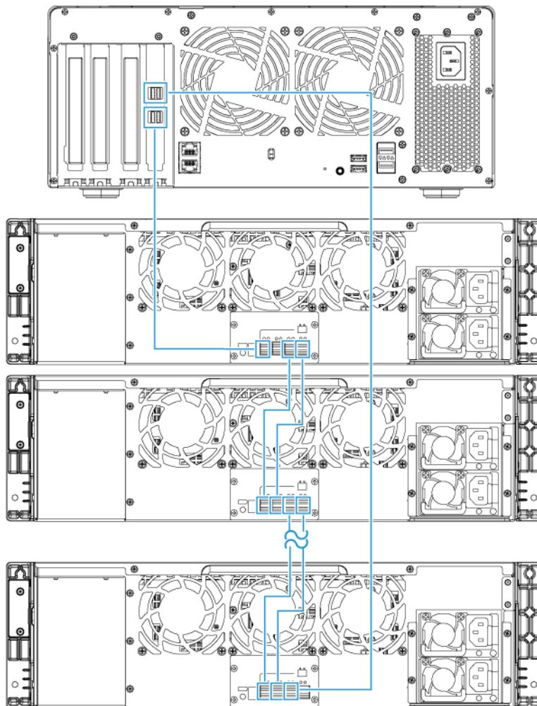
QNAP에서는 확장 장치 고장 또는 케이블 연결 해제로 인한 스토리지 다운타임을 방지하기 위해 항상 이중 경로 구성을 사용할 것을 권장합니다. 단일 경로 구성을 이중 경로 구성을 사용할 수 없는 상황에서만 사용해야 합니다.
