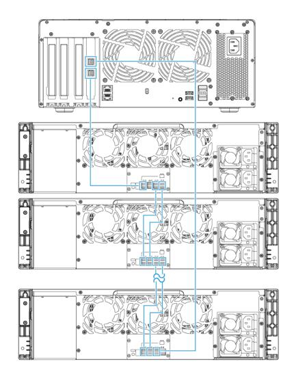
QNAP 建议始终使用双通道配置,以防止因扩展单元故障或线缆断开而导致存储停机。只有在无法使用双通道配置的情况下,才应使用单通道配置。
