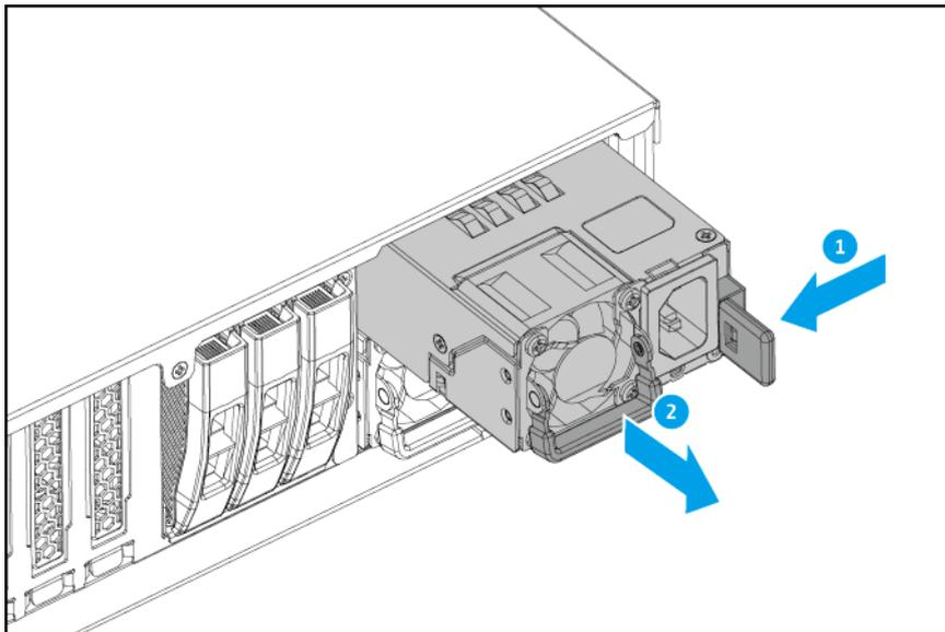
3. Setzen Sie die neue PSU ein.
