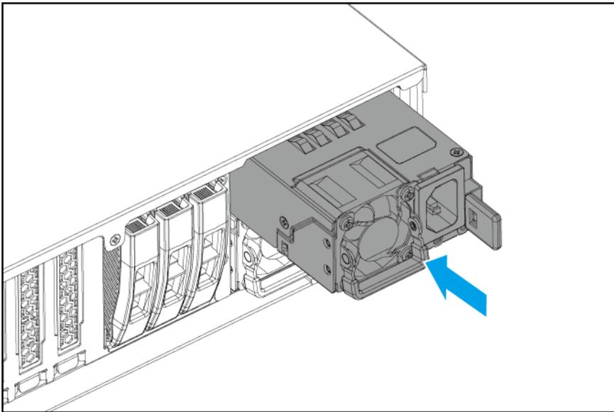
4. Schließen Sie das Netzteil an die PSU und an die Steckdose an.
