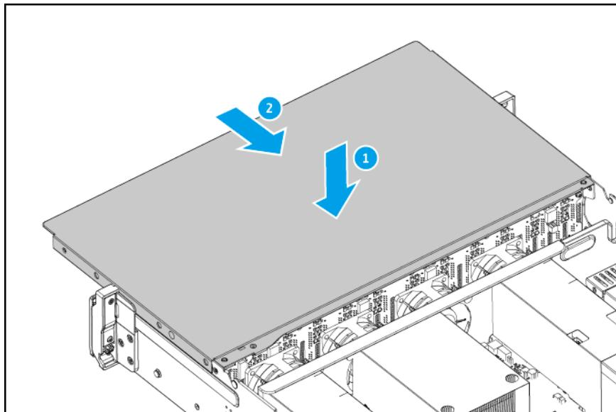
c. 装上用于将前顶盖固定到机箱的螺丝。
