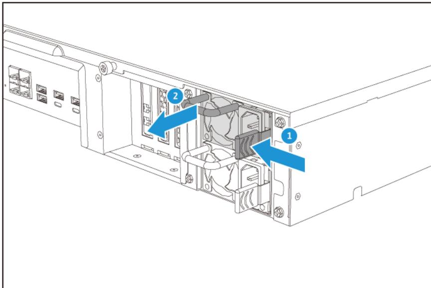
4. Setzen Sie die neue PSU ein.
