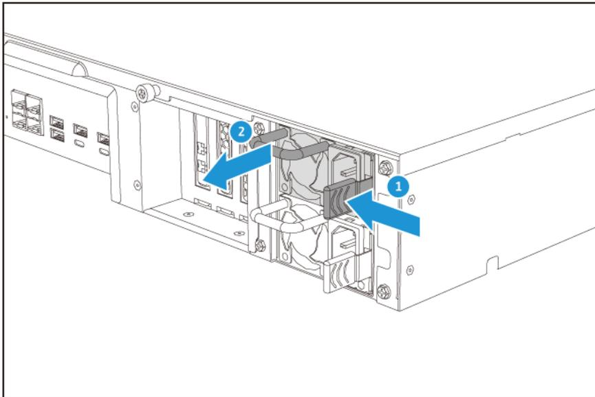
4. Setzen Sie die neue PSU ein.
