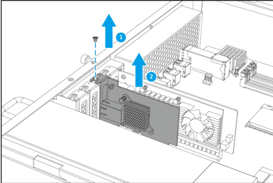
**6.** Optional: Montieren Sie die QNAP Halterung an der Erweiterungskarte.
