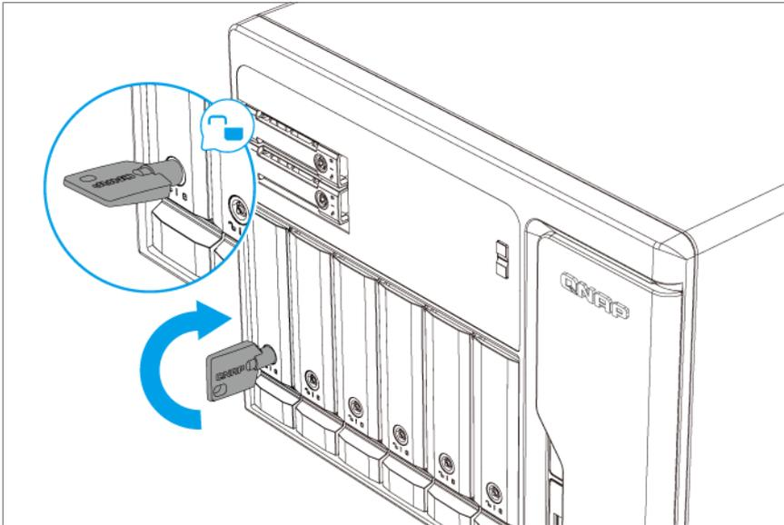
**b. Schieben Sie den Riegel nach unten.****c. Ziehen Sie am Griff, um den Laufwerkseinsatz zu entriegeln.****d. Ziehen Sie den Einsatz heraus.**
