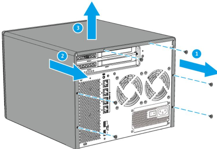
5. Entfernen Sie die PCIe-Abdeckung.
