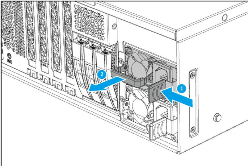
3. Setzen Sie die neue PSU ein.
