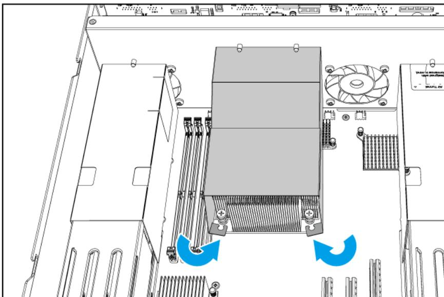
9. Bringen Sie die Schrauben an, mit denen die Lüftereinheit am Gehäuse gesichert wird.
