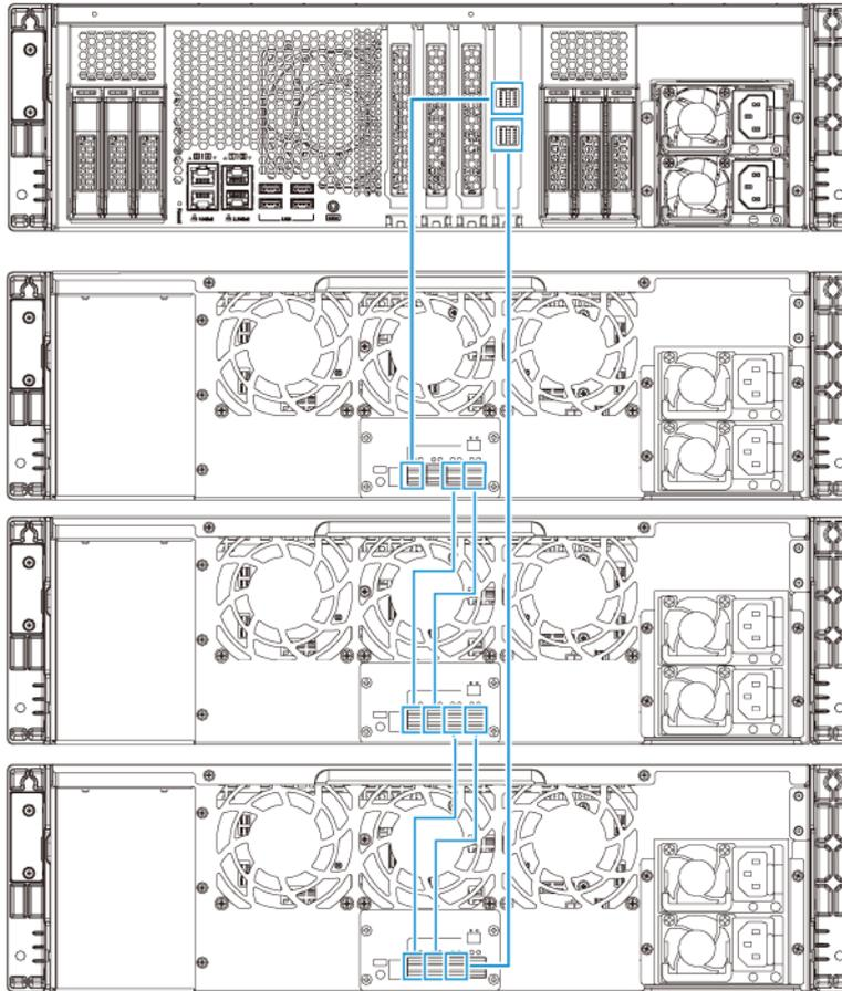
QNAP empfiehlt, immer eine Dual-Pfad Konfiguration zu verwenden, um Speicherstillstände aufgrund von Ausfall des Erweiterungsgeräts oder Kabeltrennung zu vermeiden. Die Einzel-Pfad Konfiguration sollte nur in einer Situation verwendet werden, in der es nicht möglich ist, die Dual-Pfad Konfiguration zu verwenden.
