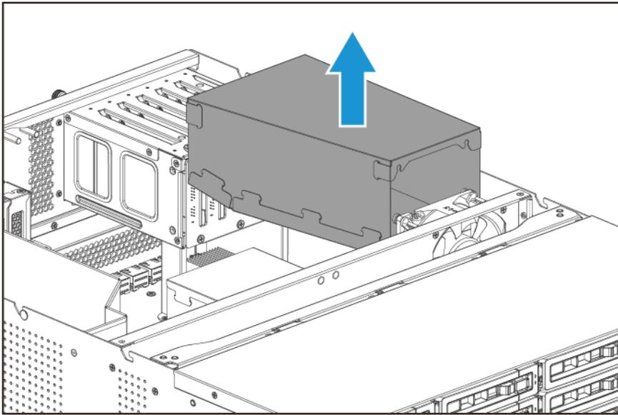
6. Entfernen Sie den CPU Lüfterkanal.
