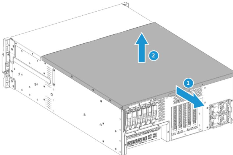
**6. Entfernen Sie die PCIe-Abdeckung.**
