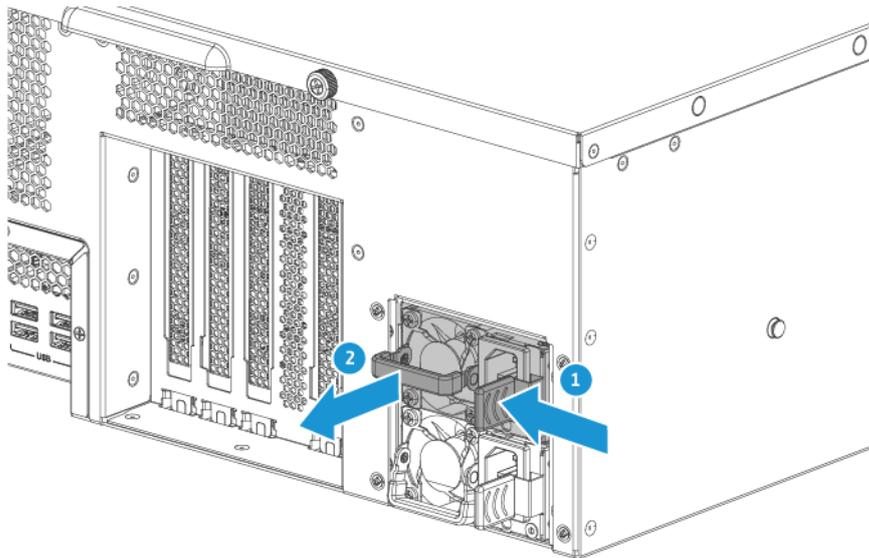
3. Setzen Sie die neue PSU ein.
