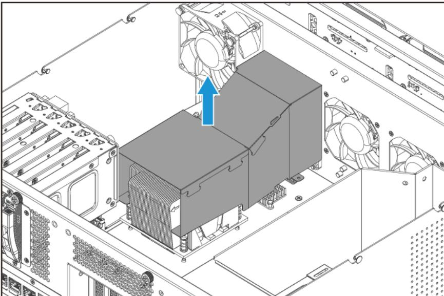
**7. Entfernen Sie die Lüftereinheit aus dem Gehäuse.**
