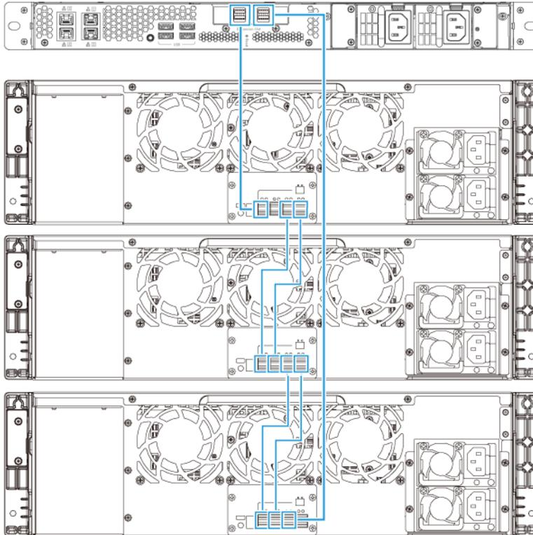
QNAP empfiehlt, immer eine Dual-Pfad Konfiguration zu verwenden, um Speicherstillstände aufgrund von Ausfall des Erweiterungsgeräts oder Kabeltrennung zu vermeiden. Die Einzel-Pfad Konfiguration sollte nur in einer Situation verwendet werden, in der es nicht möglich ist, die Dual-Pfad Konfiguration zu verwenden.
