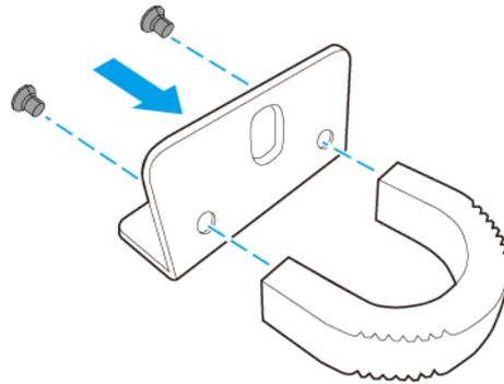
3. Installieren Sie die Winkelhalterung am Gerät.
