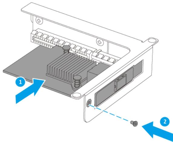
**9.** Setzen Sie die PCIe-Halterung ein.
