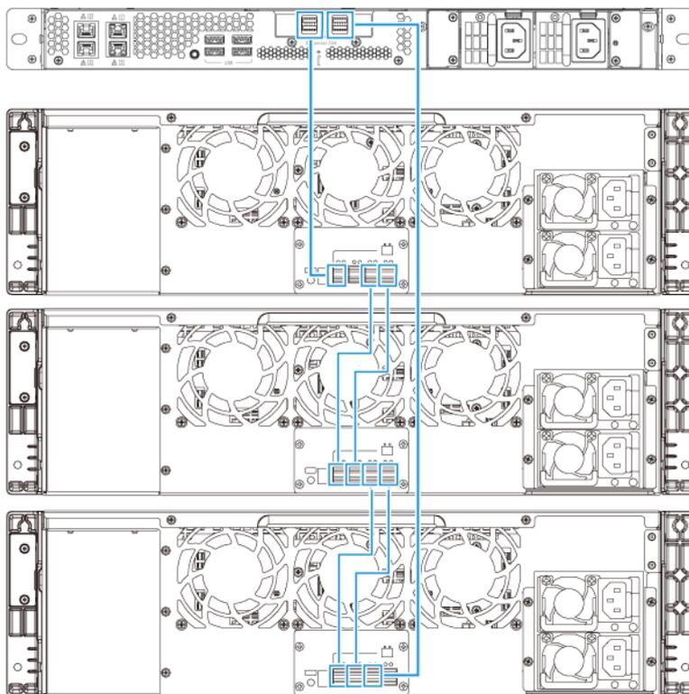
QNAP consiglia di usare sempre una configurazione a due percorsi per evitare l'inattività dell'archiviazione dovuta a malfunzionamenti dell'unità di espansione o lo scollegamento del cavo. La configurazione a singolo percorso deve essere usata solo in casi in cui non è possibile usare la configurazione a due percorsi.
