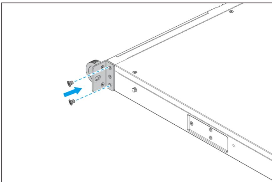
4. Installare una seconda maniglia sull'altro lato dello chassis.
