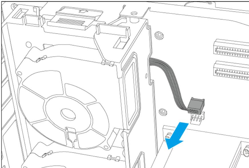
b. Entfernen Sie die Schraube, mit der das Lüftermodul am Gehäuse gesichert wird.
