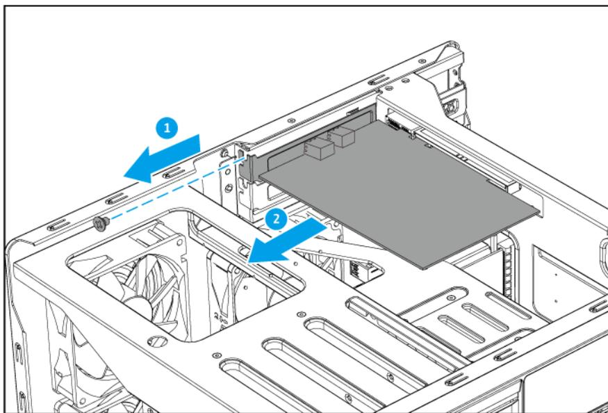
7. Entfernen Sie die PCIe-Abdeckung.
