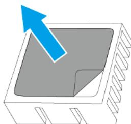
c. Installieren Sie den Kühlkörper auf dem Controller.
