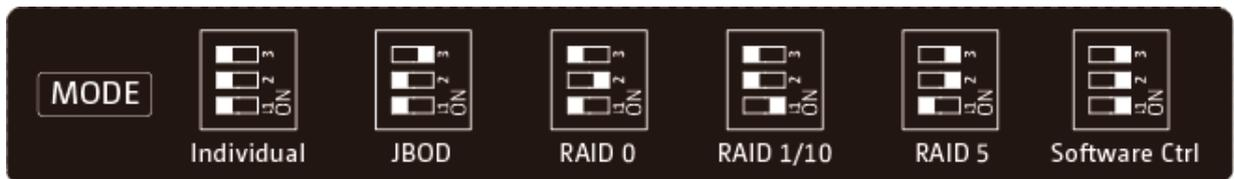
上図に示したように、RAID エンクロージャーのリアパネルにあるモードスイッチを対応する位置に動かすことで RAID 設定を手動で設定できます。
