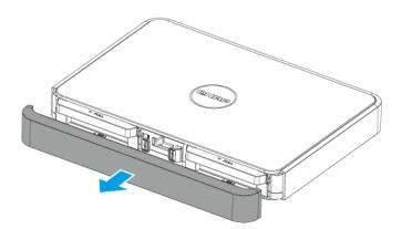
3. Rimuovere un vassoio unità premendo contemporaneamente il dispositivo di blocco e tirando il vassoio.
