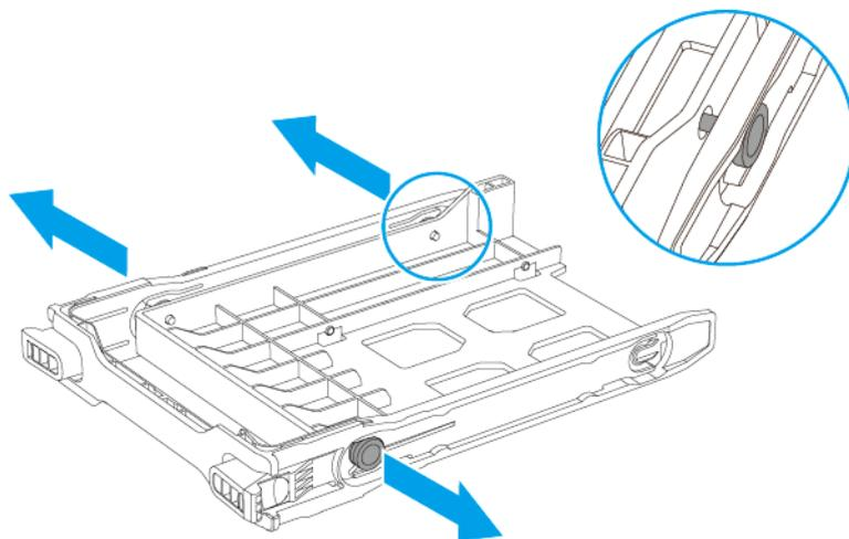
2. Inserire il perno destro posteriore sul carrello vassoio.
