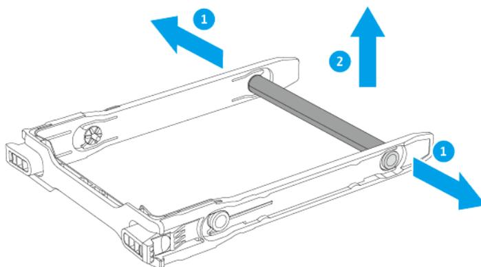
3. Rimuovere il perno destro posteriore del carrello vassoio.
