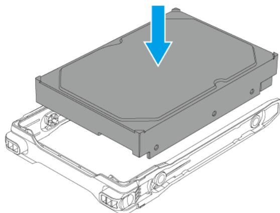
**d.** ドライブ側面の穴がトレイ側面の穴に合うようにして、ドライブをトレイの上に置きます。
