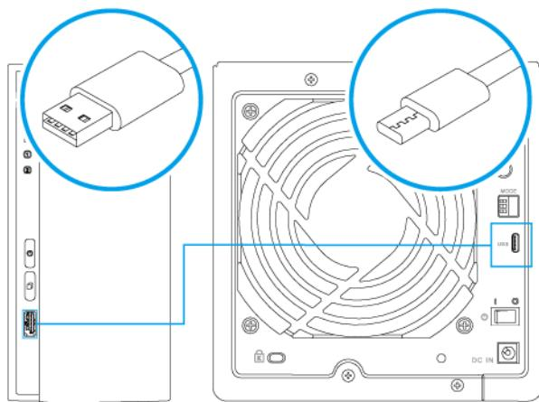
**TS-233****2. 拡張ユニットの電源をオンにします。****3. 拡張ユニットが NAS で認識されていることを確認します。**
