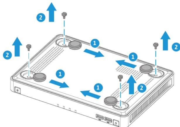
d. 下部カバーを持ち上げて NAS から外します。
