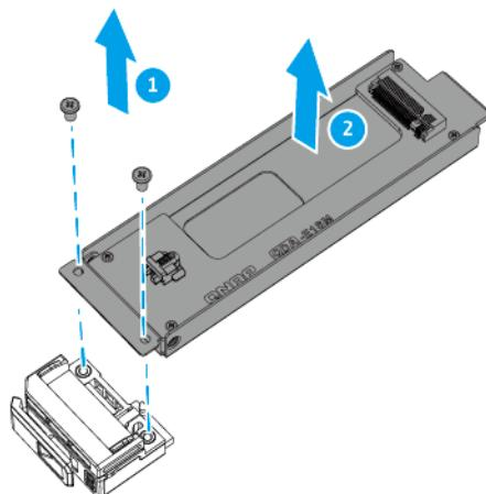
**c.** 将硬盘放在托盘底座上，使硬盘上的孔与托盘底座上的孔对齐。
