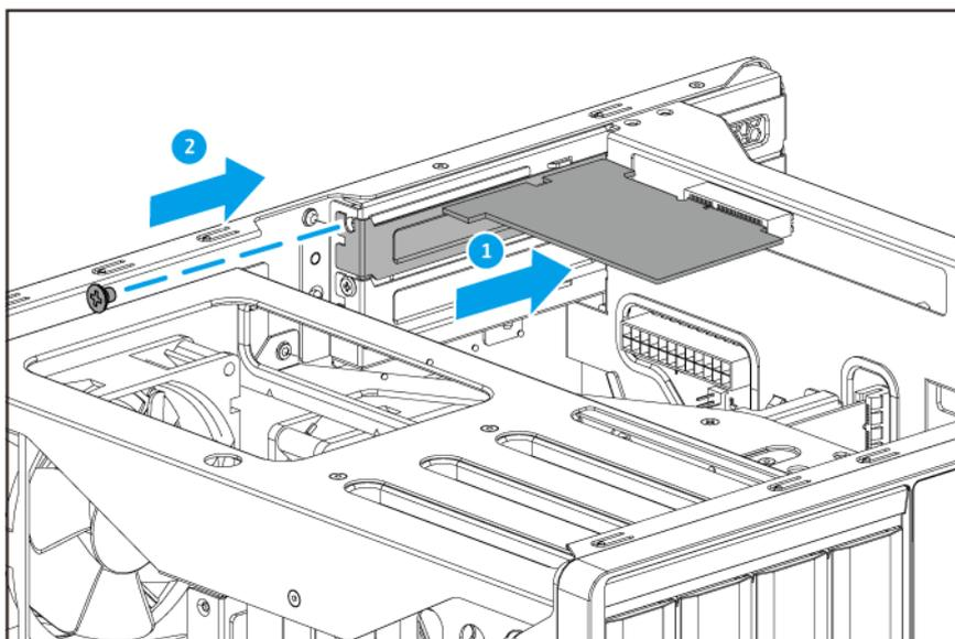
**Puerto de altura completa de conexión PCIe**
