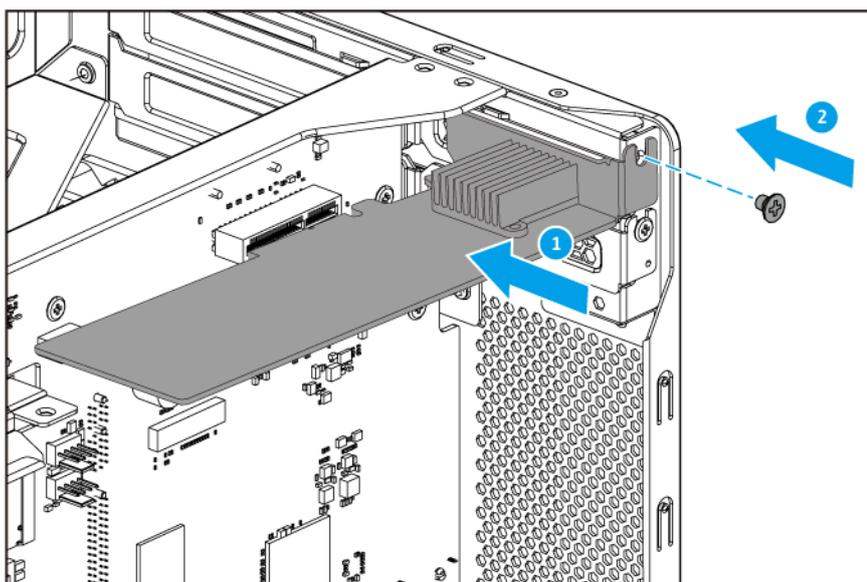
**Puerto de perfil bajo de conexión PCIe**
