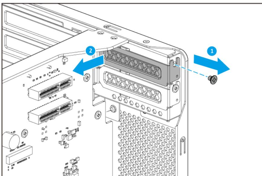
**Cubierta para PCIe de perfil bajo**
