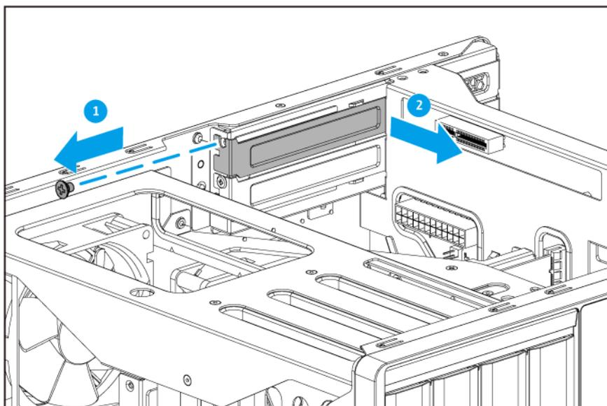
**Cubierta para PCIe de altura completa**
