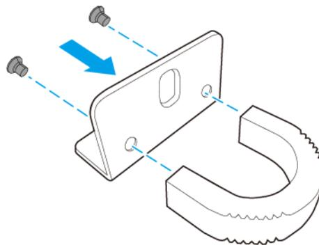
3. Installieren Sie die Winkelhalterung am Gerät.
