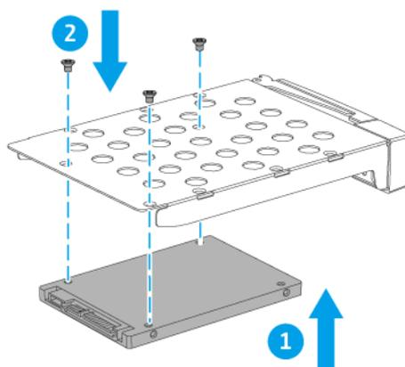
4. Setzen Sie den Einsatz in den Laufwerkschacht ein.
