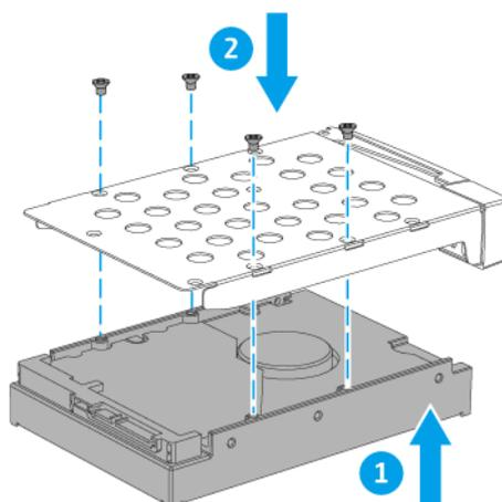
**4. Setzen Sie den Einsatz in den Laufwerkschacht ein.**
