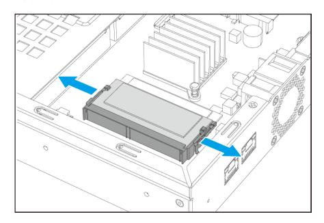
**b.** 確認記憶體模組已向上傾斜且完全從插槽鬆脫。
