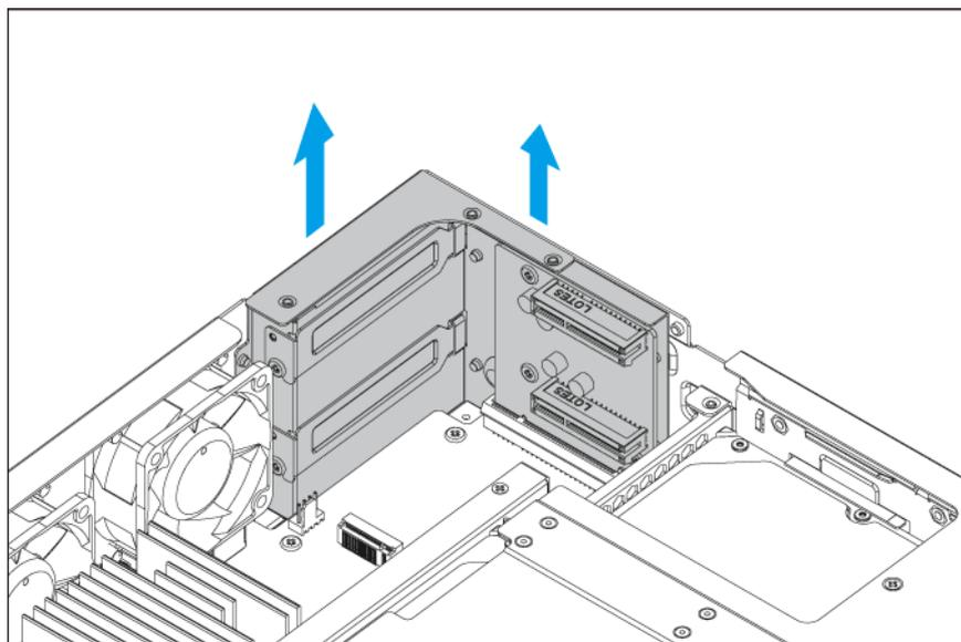
**6.** Retire la cubierta para PCIe.
