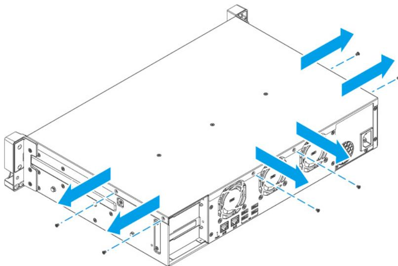
**b. カバーをスライドして戻します。****c. カバーを持ち上げてデバイスから外します。**
