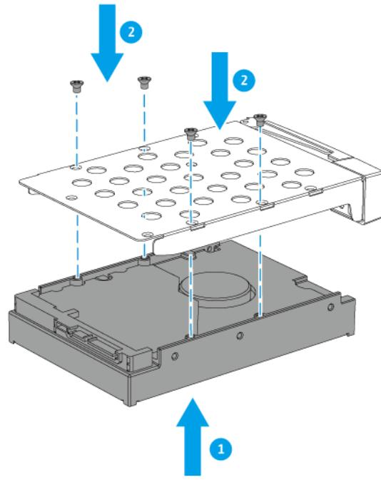
**4.** 將托盤裝入插槽。
