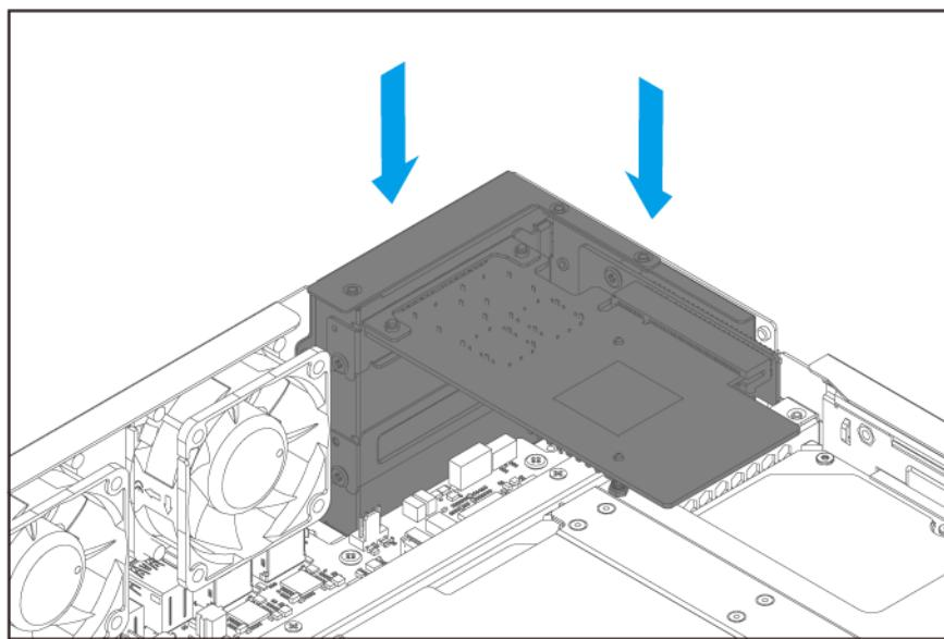
**c.** 確認擴充卡是否已完全插入 PCIe 插槽。
