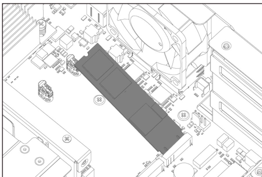
c. 小心按住 M.2 SSD，直到墊片固定住硬碟為止。
