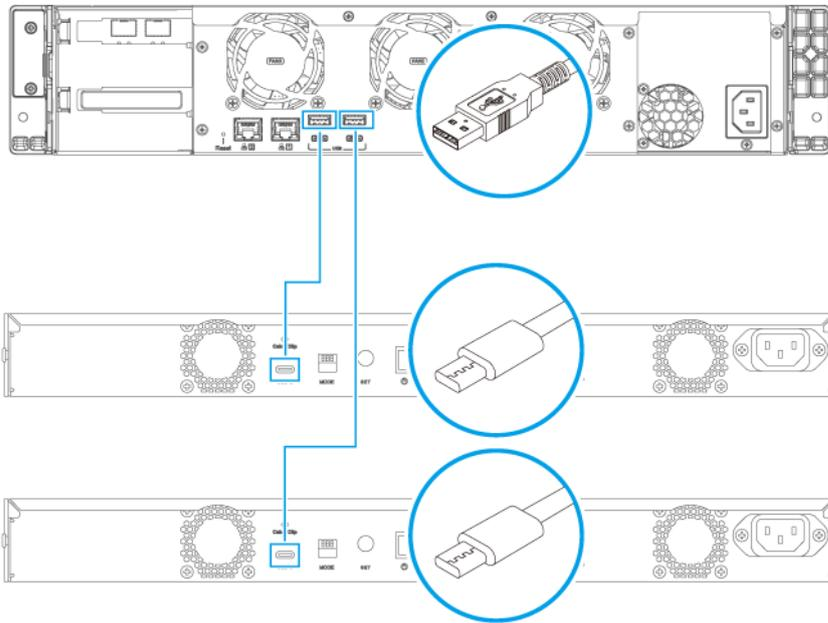
**Anschließen an einen USB Typ-A Anschluss am NAS**
