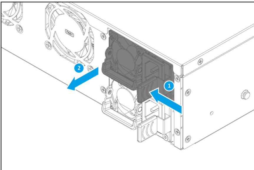
3. Setzen Sie das neue Netzteil ein.
