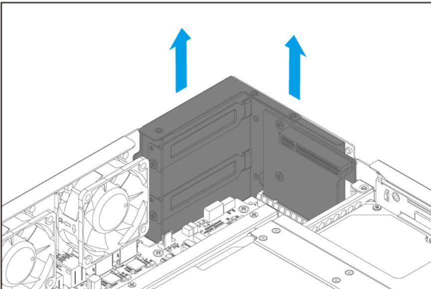
6. Entfernen Sie die PCIe-Abdeckung.
