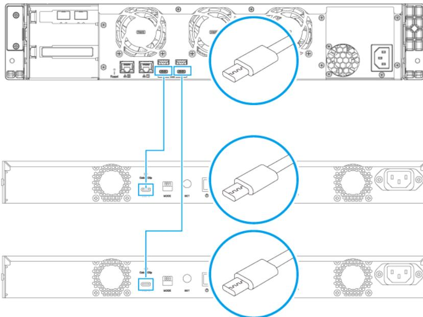
**Anschließen an USB Typ-C Anschlüsse am NAS**
