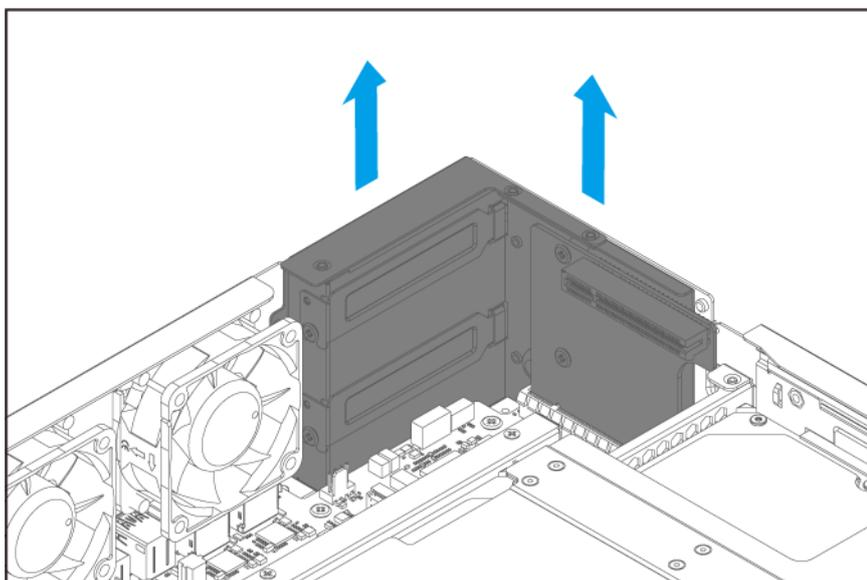
6. Entfernen Sie die PCIe-Abdeckung.
