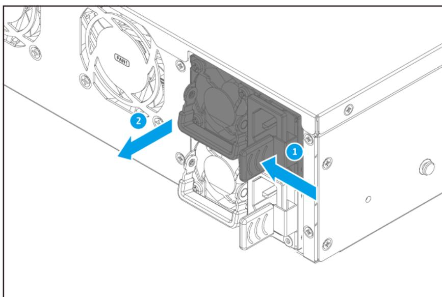
3. Setzen Sie das neue Netzteil ein.
