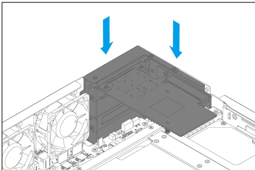
**c.** Verificare che la schede di espansione sia completamente inserita nella presa PCIe.
