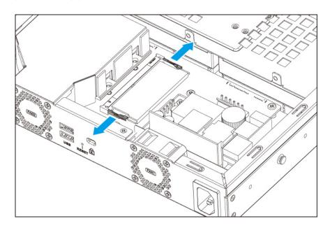
**b.** 确认模块向上倾斜并已完全脱离插槽。
