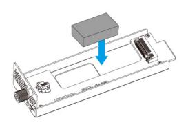
**b.** 在厚导热片上安装薄导热片。
