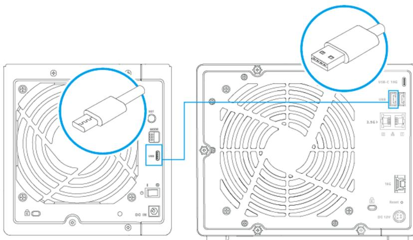
**Collegamento a una porta USB 3.2 Gen 2 Tipo A sul NAS.**
