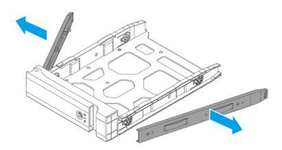
**b.** 将硬盘放在托盘上,使硬盘两侧的孔与托盘两侧的孔对齐。
