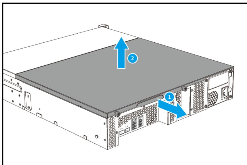
**6. Entfernen Sie die PCIe-Abdeckung.**
