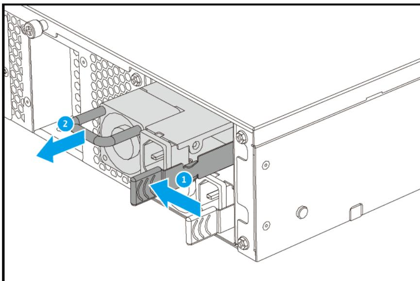
4. Setzen Sie die neue PSU ein.
