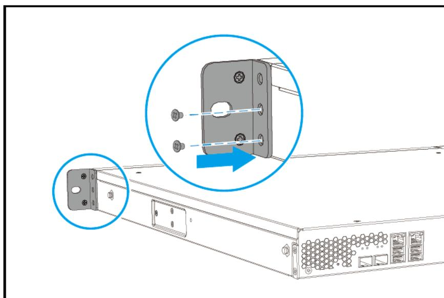
4. Installieren Sie einen zweiten Griff auf der anderen Seite des Gehäuses.
