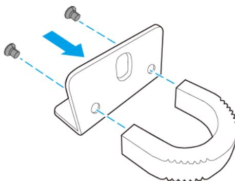
3. Installez le support en équerre sur l'appareil.
