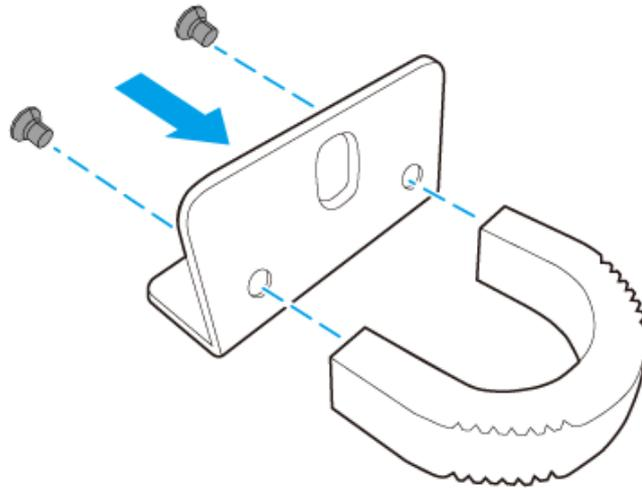
3. Installieren Sie die Winkelhalterung am NAS.
