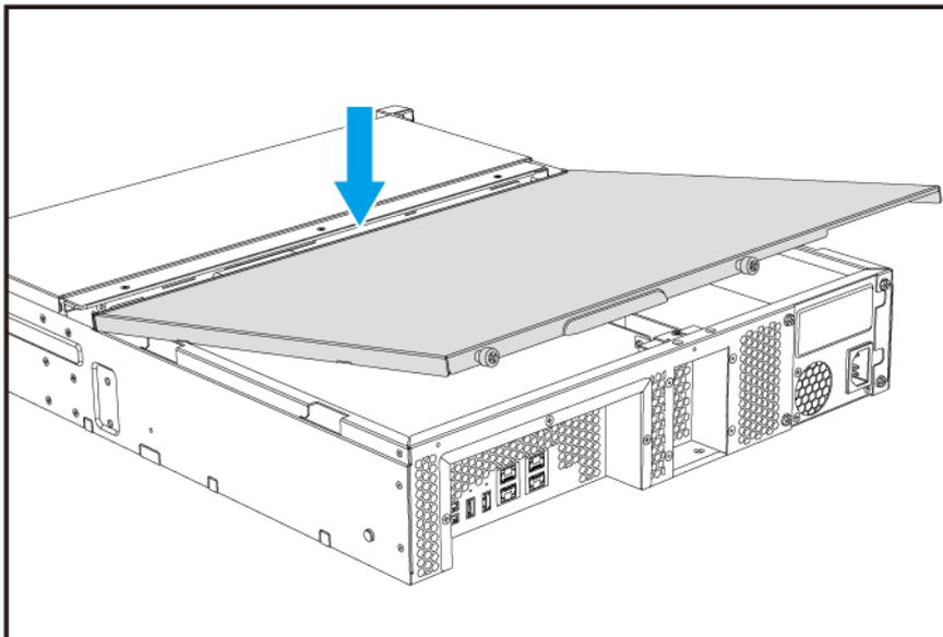
**b.** Schieben Sie die Abdeckung in Richtung des NAS.
