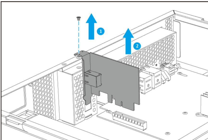
**7. Montieren Sie die QNAP-Halterung an der Erweiterungskarte.**
